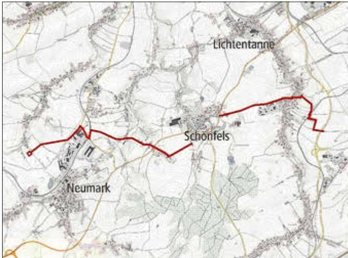
Beim Projekt „Werdauer Ast“ werden ca. 10 km Trinkwasserleitung gebaut bzw. erneuert (rote Markierung) sowie ein großer Hochbehälter in Beiersdorf errichtet. Quelle: ALKIS,TK10 – GeoSN, dl-de/by-2-0; Bestandsdaten – Wasserwerke Zwickau GmbH
